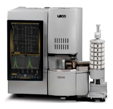
美国力可碳硫分析仪CS744系列采用了采用触摸屏技术和在线软件平台,重新定义在钢铁、矿石、金属成品及其他无机材料中碳硫分析的新模式;同时也增强了仪器的可操作性,降低了分析成本。美国力可碳硫分析仪CS744系列采用了\*\*\*的仪器设计,如高效高频感应炉,改进的红外检测池,全自动分析系统使CS744碳硫仪成为一台可在任何实验环境下准确分析碳硫的分析仪器[ornerstone分析软件采用触摸屏界面使用户可完整的达到分析控制、方法设定、在线诊断、数据报告[Cornerstone碳硫分析软件允许用户在单一分析界面中完成日常的所有工作,快速而且简单易用,力可创新的批次和重复样品数据分组功能极大简化了样品结果输出和结果标准偏差的自动计算,减少了繁琐的额外数据处理。
